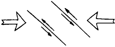
图 1 平行同旋断层减震原理
